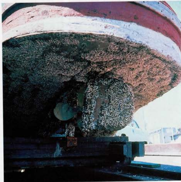
Sehr starker Schiffsbewuchs mit röhrenbauenden Borstenwürmern. Foto: Carlton
