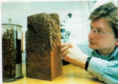
Dr. Gollasch untersucht einen von dem Schiffsbohrwurm zerfressenen Holzbalken.
