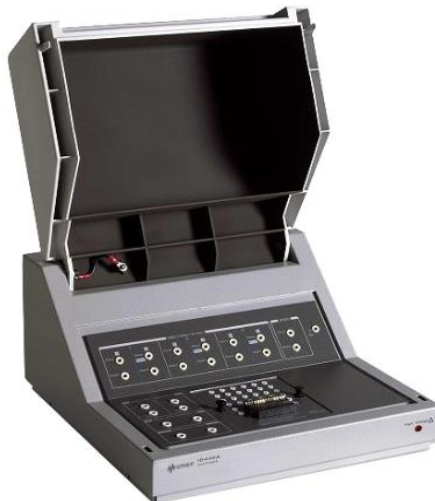
Figura 20: Sistema de medição utilizado para medir as curvas de transferência e output dos vários fototransistores: (a) Sistema mainframe Keysight B1500A; (b) Caixa de testes Keysight 16442B;
