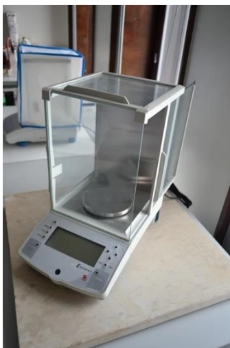
Joonis 22. Emanatsioonimõõtmistel kasutatud kaal Ohaus Explorer .
