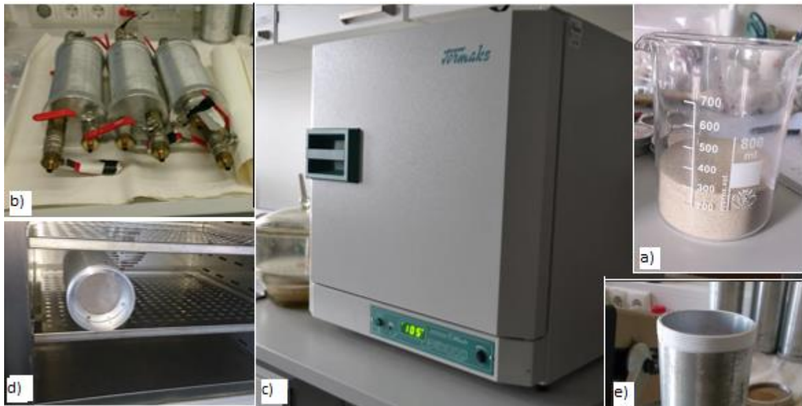
Joonis 17. Ettevalmistused radooni mõõtmiseks: a) 0,3 l liivaproovi mõõtmine; b) radoonikambrid koos kaantega, millel 2 kuulkraani; c) kasutatud kuivatuskapp (Fermaks); d) radoonikamber (sõeladega suletud) liivaprooviga kuivatuskapis; e) teflonteip radoonikambri keermetel enne kaane peale keeramist.
