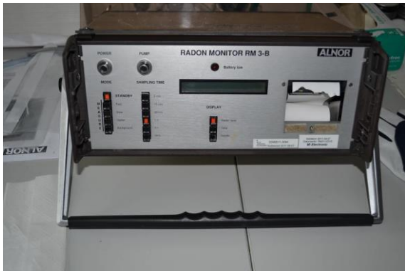
Joonis 8. Tahkisedetektorit kasutav Alnor mõõteseade Radon Monitor RM3-B.
