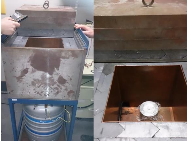
Joonis 21. Planaardetektor väljast ja seest.
