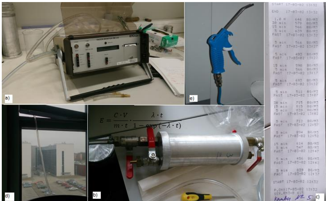
Joonis 18. a) radoonimonitoril vooliked küljes, vool on sees (ülemises vasakus nurgas oranž nupp, parempoolne on pump), kuid ooterežiimis (vasakpoolne oranž kandiline nupp), tulemused tulevad iga 30 min tagant; b) vooliked radoonikambri küljes, kraanid suletud; c) termopaberil tulemused; d) radoonimonitori ventileerimine välisõhuga; e) radoonikambrite ventileerimiseks kasutatud suruõhupüstol.
