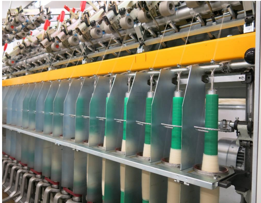
Foto 21. Lõngade ketramine ketrusmasinal. Foto: Astri Kaljus
