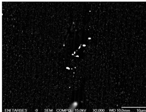
Figure III-13 : Micrographie MEB en électrons rétrodiffusés de la matrice, des précipités grossiers et des précipités aciculaires.
