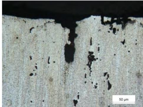
Figure IV-48 : Défaut de corrosion intergranulaire associé avec la piqûration.
