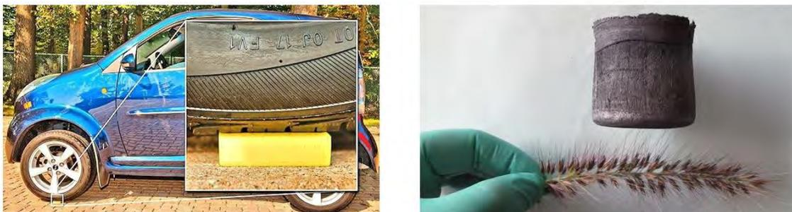
Figure 13 - (a) Illustration des propriétés de résistances mécaniques d'un aérogel développés pour la « NASA (National Aeronautics and Space Administration) », (b) Pièce d'aérogel soutenue par les ramifications d'une graminée sans que celles-ci ne ploient <sup>78</sup>.
