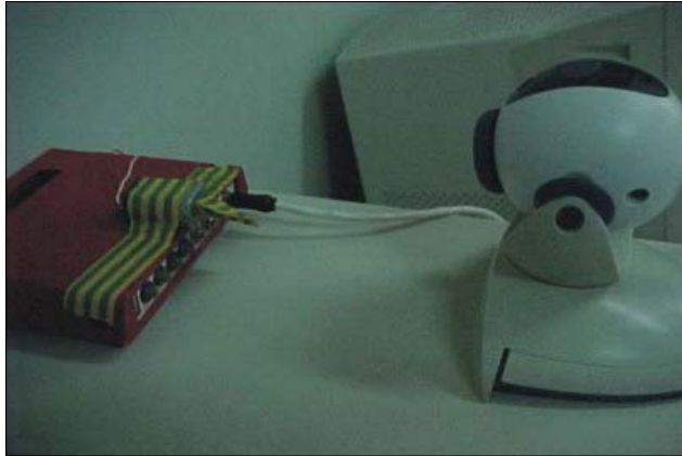
1. ábra. Internet segítségével látható és irányítható léptető motor interfész egysége
