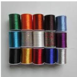
Benang logam yang umumnya dipergunakan dalam pertekstilan bukanlah logam mulia melainkan alumunium tipis yang direkatkan pada 2 helai film plastic sebab alumunium mempunyai sifat baik yang lembut, ringan, serta murah harganya jika dibandingkan dengan logam lainnya. Benang logam berfungsi untuk menghias tekstil keperluan rumah tangga, sebagai pakan pada tenunan macam- macam daerah, dan ita- pita hias.
