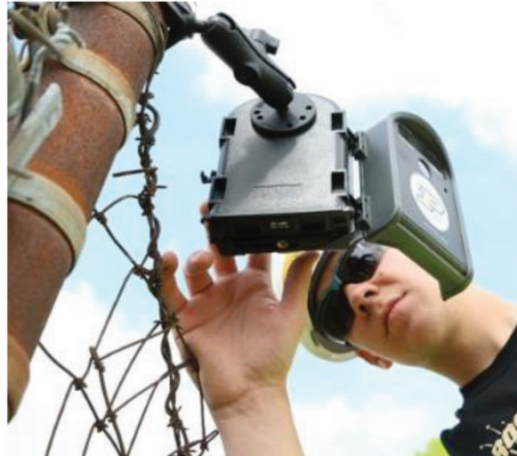
(d) Batteries are accessible from bottom
