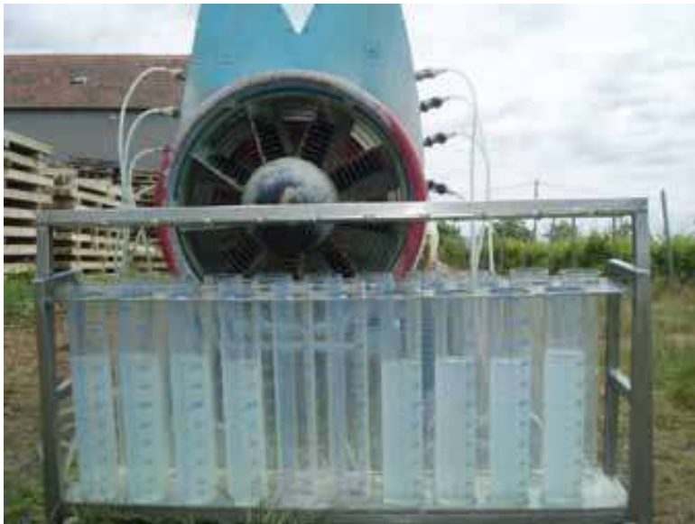
Slika 3. Uređaj za mjerenje protoka mlaznica na raspršivačima Figure 3. A measuring device for mistblower nozzle flow
