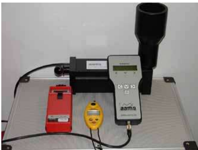
Slika 4. Uređaj za mjerenje protoka mlaznica na prskalicama Figure 4. A measuring device for sprayer nozzle flow
