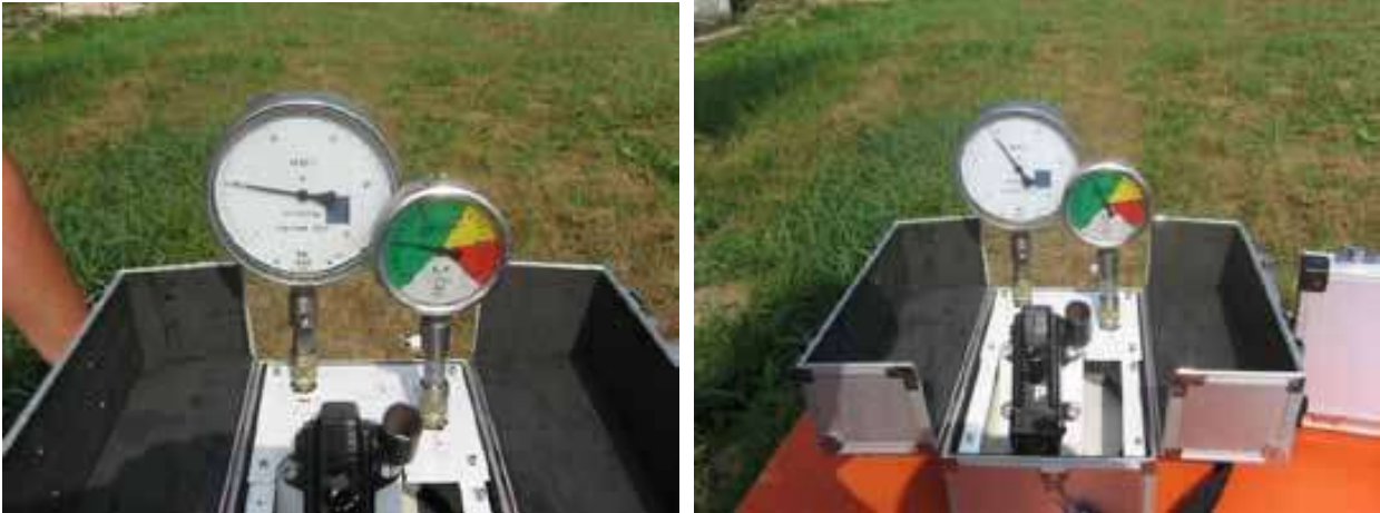
Slika 1. Uređaj za mjerenje ispravnosti rada manometra Figure 1. A measuring device for pressure gauge correctness
