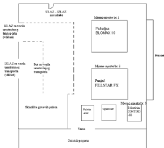
Slika 1. Prikaz proizvodnog procesa s označenim mjernim mjestima
