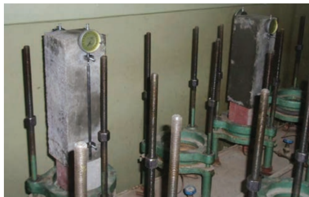
Slika 5. Mjerenje skupljanja betona
