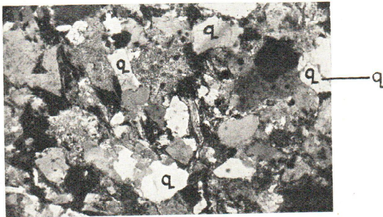
Sl. 3. Krupnozrni peščar (povečanje 48 puta). q = kvarc
