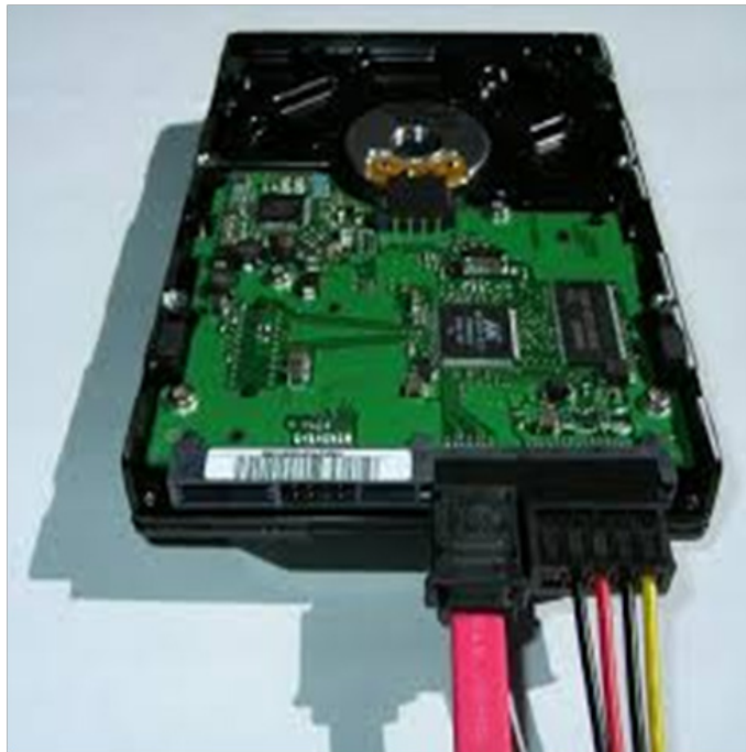
Slika 2: HDD priključen S-ATA kablom Izvor: https://de.wikipedia.org/wiki/Serial_ATA
