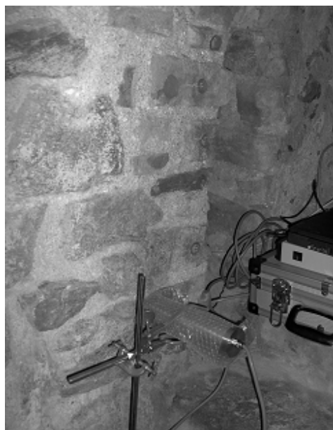
Figure 33 : mesure de la radioactivité gamma d'une maçonnerie et du rayonnement cosmique par spectrométrie gamma de terrain (château de Mayenne, Mayenne, France). La sonde de détection sensible au rayonnement gamma est placée face à la zone de prélèvement. Elle est constituée d'un scintillateur NaI:Tl qui convertit l'énergie des gamma en scintillations: le nombre de photons détectés est proportionnel à l'énergie déposée. Un tube photomultiplicateur associé à un système de traitement du signal permet de faire le spectre de l'énergie reçue.
