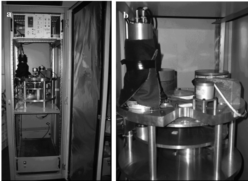
Figures 26 a & b : Appareils de TL construits et utilisés au CRP2A. Vue générale et détail de la partie centrale, où ont lieu les phases d'irradiation, de chauffage et de détection du signal (clichés CPR2A).
