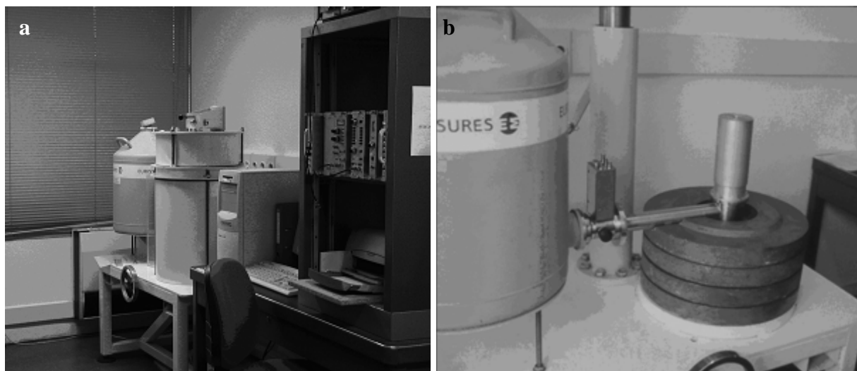
Figures 31 a & b: appareillage de spectrométrie gamma à bas bruit de fond utilisé au laboratoire de Bordeaux (de type EGPC 200 P 17, Eurisys Mesures). Le dispositif s'organise autour d'un détecteur germanium puits, refroidi à l'azote liquide. Le détecteur est entouré d'une couronne de plaques de plomb de faible activité, destinées à absorber le rayonnement \gamma provenant de l'environnement du détecteur (photos IRAMAT-CRP2A).
