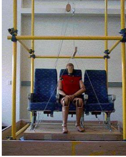
Şekil 1: Uçak yolcu koltuđu, ATD ve platformu ieren bir dűşürme kulesi
