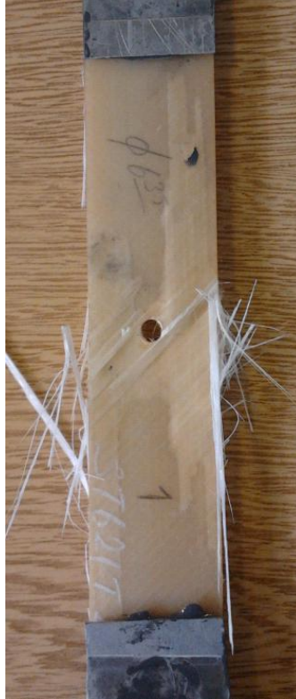
Şekil 3: Levhanın kırılma sonrası görünümü
