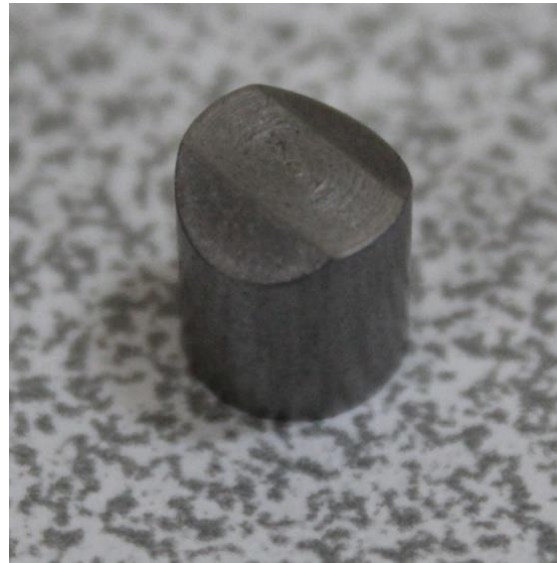
Şekil 4. Hız ölçüm sistemi ve 0.3 kalibre çelik mermi
