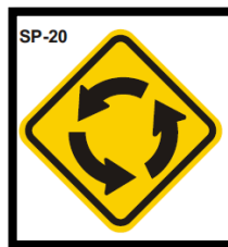
Figura 39. Señal aproximación de glorieta.
