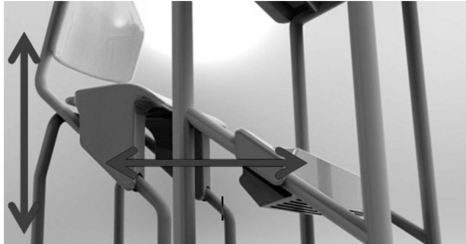
Imagen 6 Propuesta de diseño. Estructura fija con regulaciones de asiento y reposapiés.
