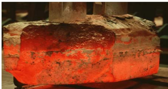
Рис. 6. Разрушение анодного блока при образовании трещины
