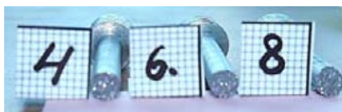
Рис. 6. Изломы образцов после испытаний на разрыв
