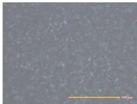
Рис. 3. Структура в поперечном разрезе слитка \varnothing 8 мм из сплава СвАМГ6
