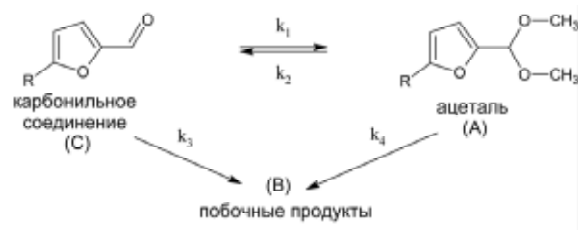
Рис. 1. Схема реакции ацеталирования фурфурола (R = H) и 5-гидроксиметилфурфурола (R = CH 2 OH) метанолом в рамках предложенной кинетической модели
