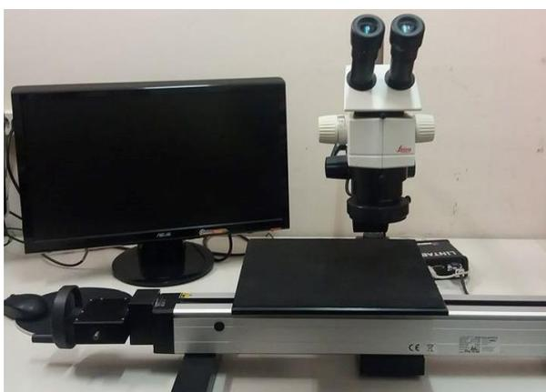
Figura 8 Mesa de medição de deslocamentos (LINTAB Linear table 560 mm / 2,5 mm); Stereo Microscope LEICA M80
