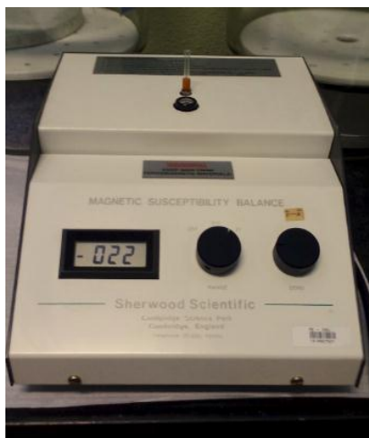
Figura 61 - Balança para medir susceptibilidade magnética.
