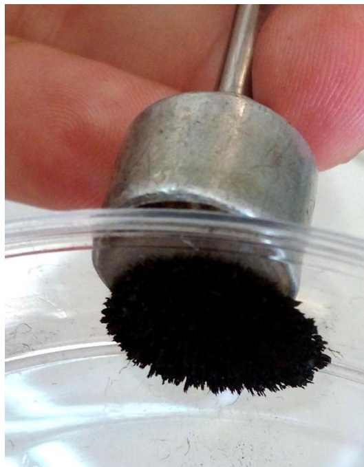
Figura 63 - Nanopartículas magnéticas de \text{Fe}_3\text{O}_4 .
