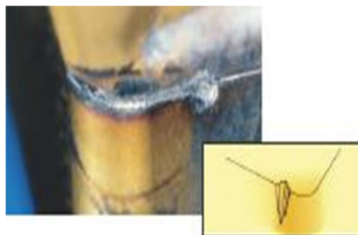
Figura 47 - Desgaste tipo Entalhe
