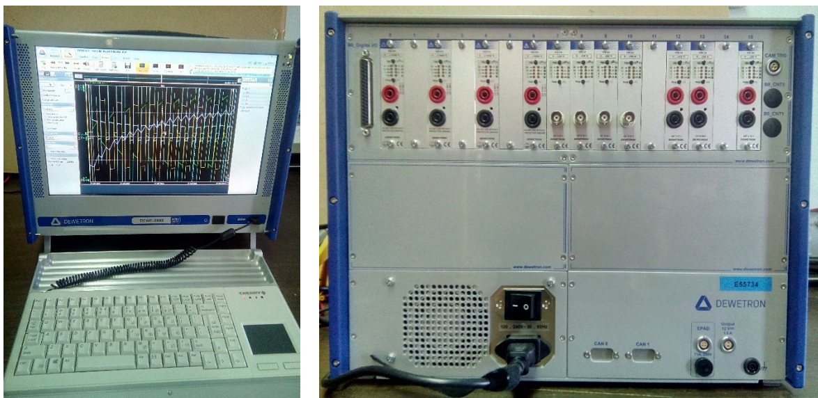
Slika 10.1: Sistem za zajem podatkov DEWETRON DEWE 2600: a) spreddaj in b) zadaj
