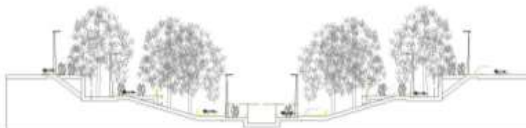
Figura 70. Corte transversal canalización
