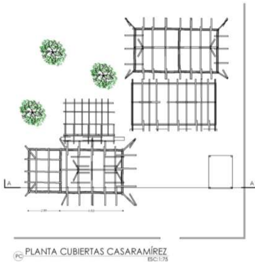
Figura 113. Planta estructura-Cubierta Vivienda Ramírez.
