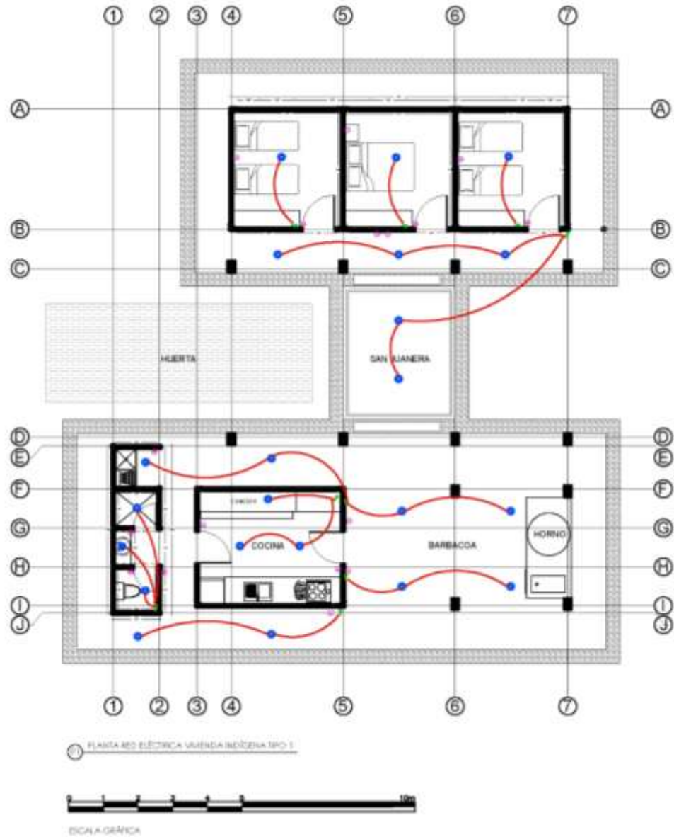
Figura 209. Planta, Red Eléctrica. Vivienda aislada tipo I
