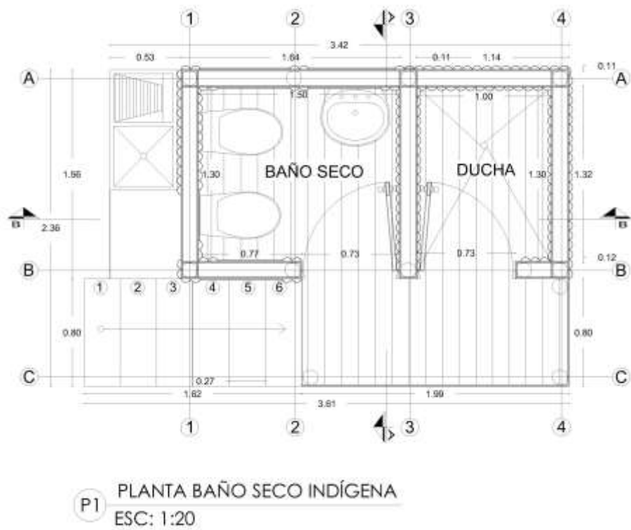
Figura 250. Planta baño seco tipo II.
