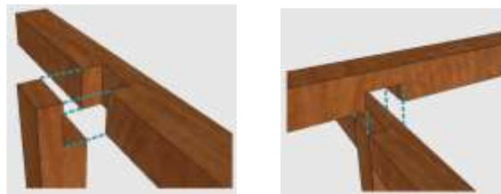
Figura 61. Unión. Estantillo-vareta, viga
