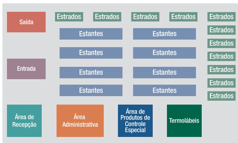
Figura 2 - Modelo de disposição interna de prateleiras e estrados em uma Central de Abastecimento Farmacêutico Fonte: Adaptado de BRASIL, 2006a
