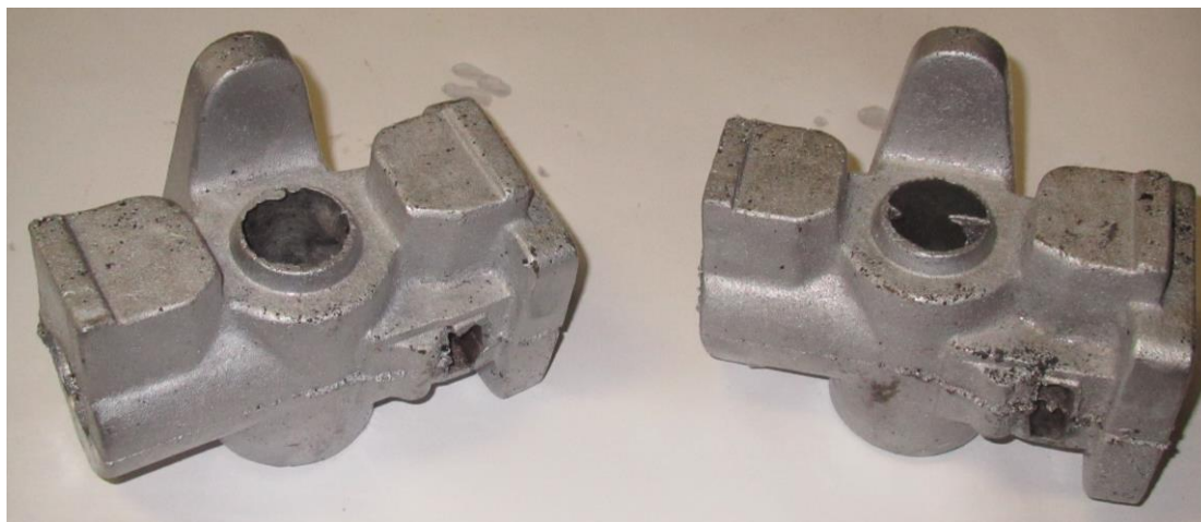
Рис. 3. Виливки, отримані з використанням розробленої стрижневої суміші
