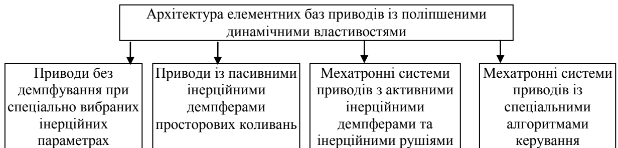
Рис. 2.11. Архітектура елементних баз та напрямки забезпечення необхідних динамічних властивостей систем приводів
