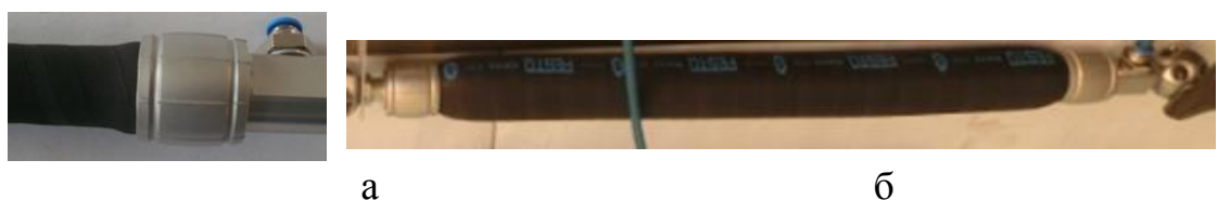
Рис. 3.32. Кінцева частина пневмодвигуна (а) та зовнішній вигляд пневмодвигуна при подачі тиску (б)
