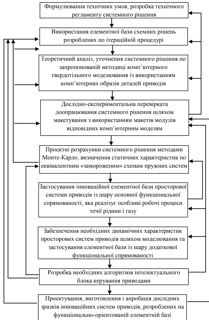
Рис. 2.29. Основні етапи розроблення елементної бази системних рішень просторових систем гідро- і пневмоприводів
