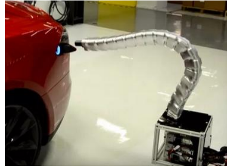
Рис. 1.5. Робот у вигляді шарнірної ланцюгової структури (а) та багатоланкова просторова система приводів для зарядки акумуляторів електромобіля (б)
