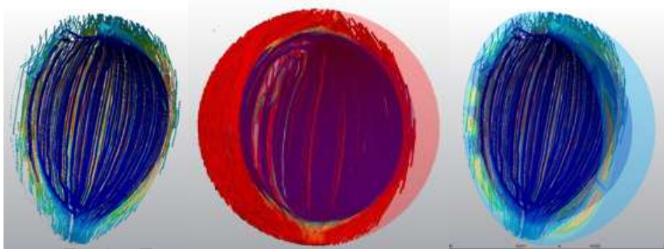
Рис. 5.9. Розрахунок на ЕОМ ліній течії в порожнині магнітного шарніра із феромагнітною рідиною
