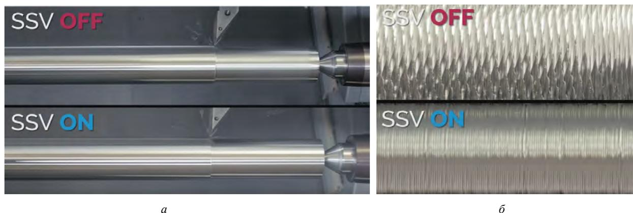
Рис. 1. Применение переменной скорости вращения шпинделя на станке фирмы HAAS:
