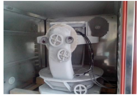
Рис. 13. БІНС в термокамері на механічному поворотному станді під час охолодження
