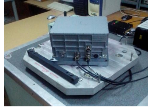
Рис. 10. Статичні випробування БІНС на розв'язаному фундаменті
