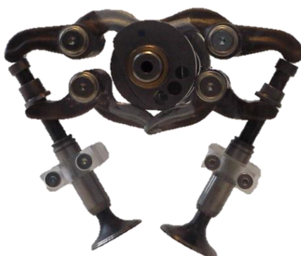
Obr. 15 – Ovládání ventilů desmodromického rozvodu [IX]
