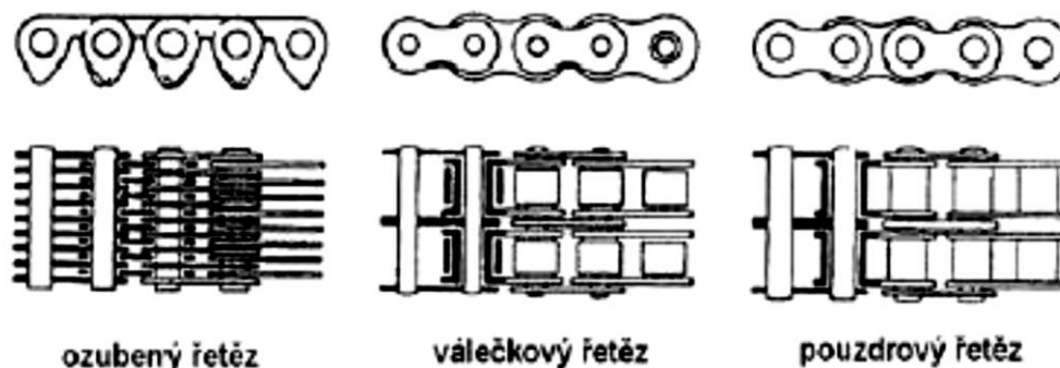
Obr. 21 – Typy rozvodových řetězů [XV]
