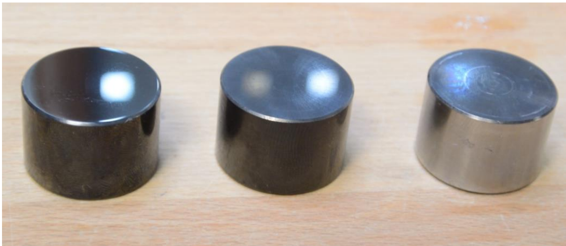
Obr. 42 – Zleva: Zdvihátko leštěné před povlakováním, Zdvihátko povlakované, Zdvihátko bez úprav [XXIII]
