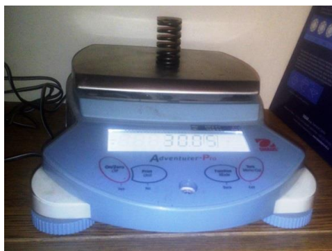
Obr. 36 – Měření hmotnosti ventilové pružiny
