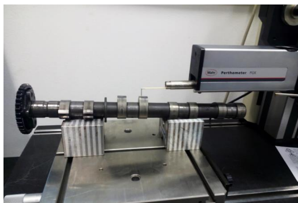
Obr. 37 – Měření drsnosti na palci vačkového hřídele
