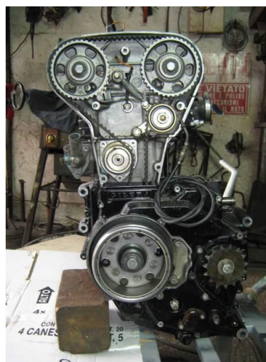
Obr. 23 – Pohled do rozvodové šachty motoru Gilera Bi4 [XVII]
