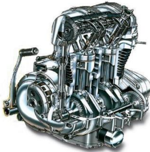
Obr. 20 – Průřez motorem Kawasaki W650 [XIV]
