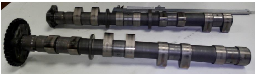
Obr. 10 – Vačkové hřídele motoru Yamaha YZF R6 (Sací v přední části, výfukový v pozadí)
