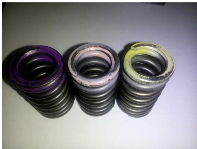
Obr. 33 – Barevné rozlišení ventilových pružin
