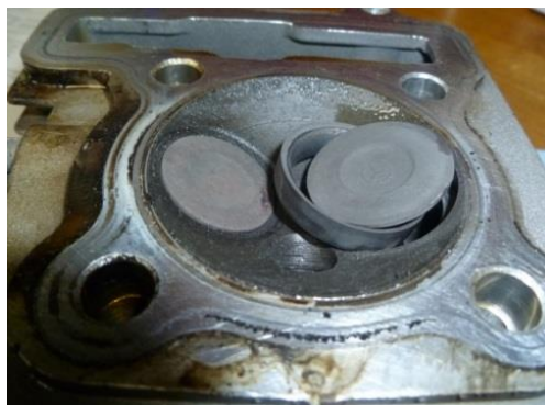
Obr. 4 – Zalisované ventilové sedlo poruchový stav [II]
