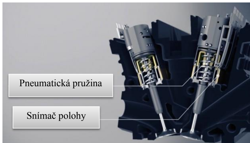
Obr. 26 – Freevalve – Detail ovládní ventilů [XIX]
