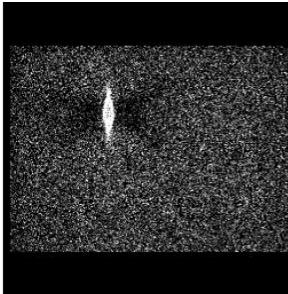
Obrázek 35: Artefakt způsobený chybným zapojením fotonásobičů [5]
