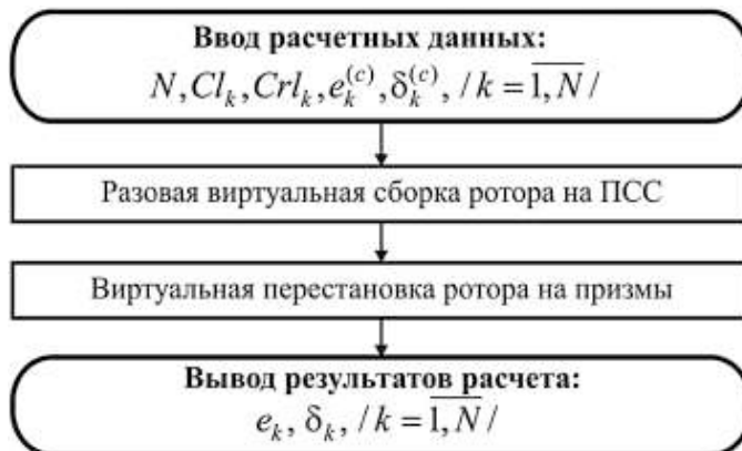
Рис. 9. Укрупненная блок-схема алгоритма разовой виртуальной сборки ротора с замером биений на призмах
