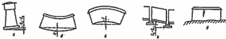
а) нахил; б) прогин; в) вигин; г) перекіс; д) тріщиноутворення Рисунок 1 – Види деформацій споруд
