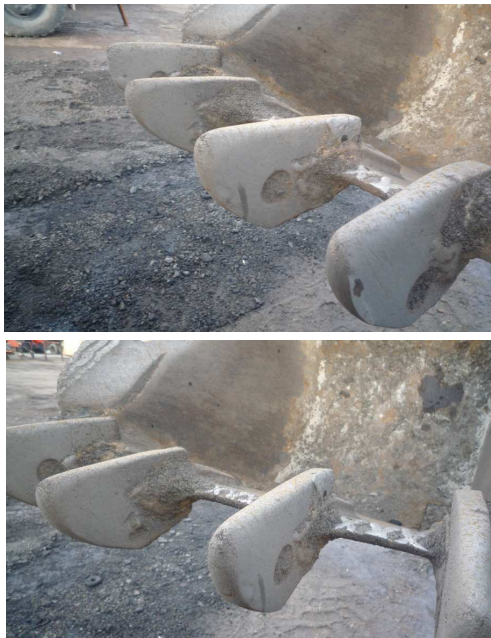
Рис. 1. Локальне зношення різальних крайок робочого органа одноківшового екскаватора ЭО-2621. (Виробничий експеримент із використанням машинного парку Кіровоградська ДЕД ДП «Кіровоградський обласвтодор»)
