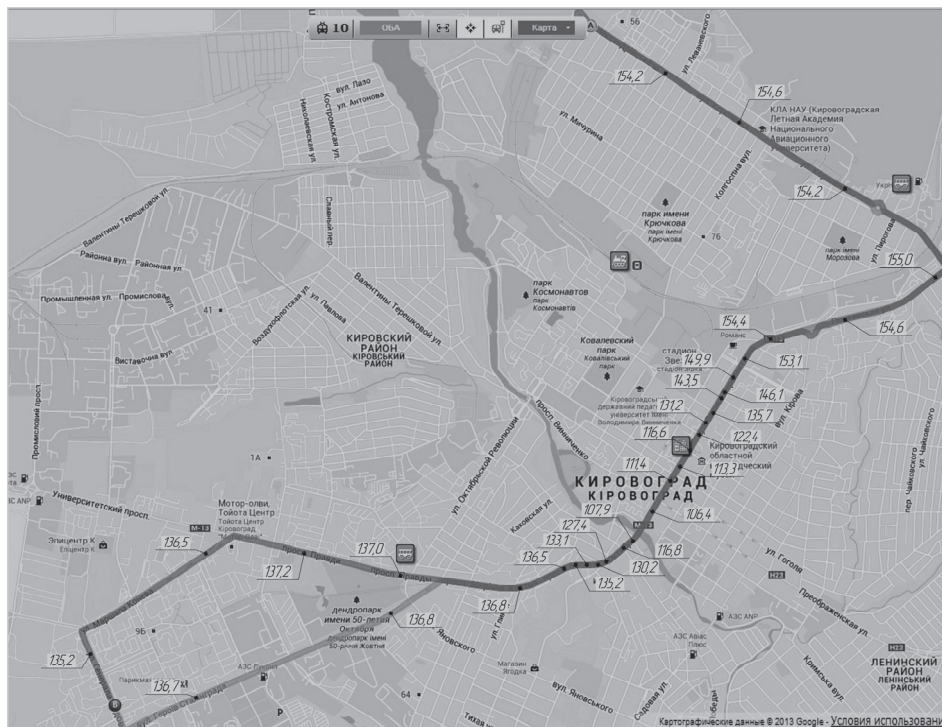
Рис. 2. Зміна висоти дорожнього покриття над рівнем моря за тролейбусним маршрутом №10 (м. Кіровоград)
