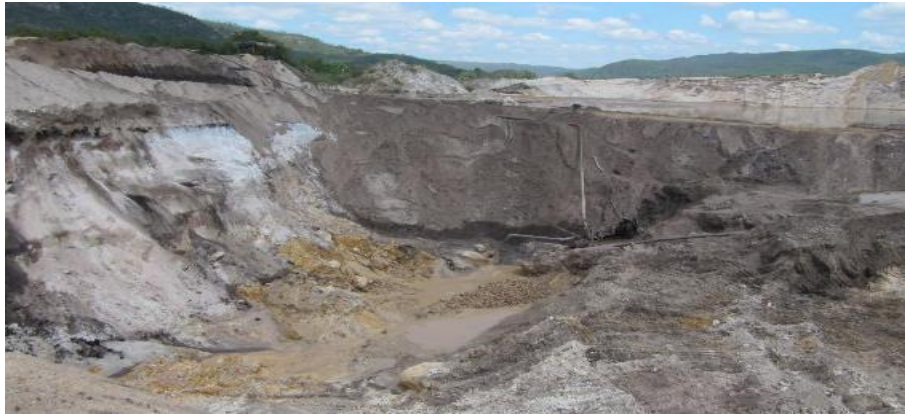
Fig. 3: Taludes gerados para abertura da cava de garimpo, apresentando instabilidades e risco de desabamento. Foto: Baggio, 2016.
