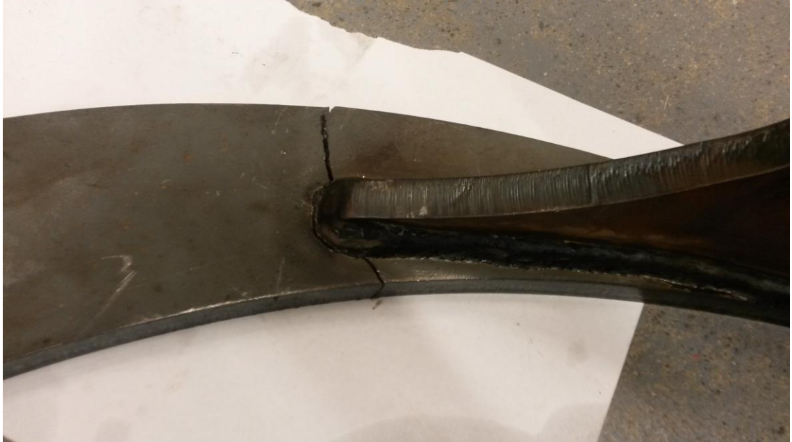
Kuvio 33. Koura 4 murtuneena. Kourassa 4 pääty oli hitsattu ympäri, mutta siitä puuttui monipalkohitsi.
