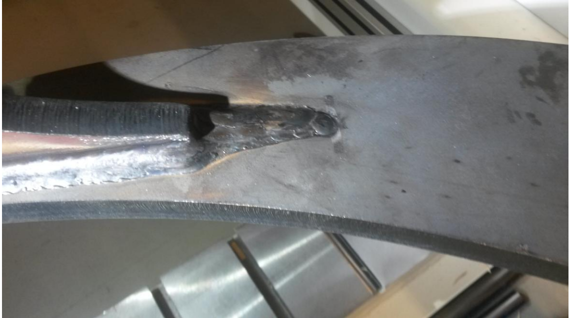
Kuvio 29. Koura 2. Päätyhitsi jatkettu pidemmälle jouhevuuden parantamiseksi.
