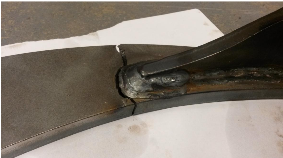
Kuvio 34. Koura 5. Monipalkohitsi päädyssä. Alkuperäisten, käytössä murtuneiden koekappaleiden mukainen reunaetäisyys.
