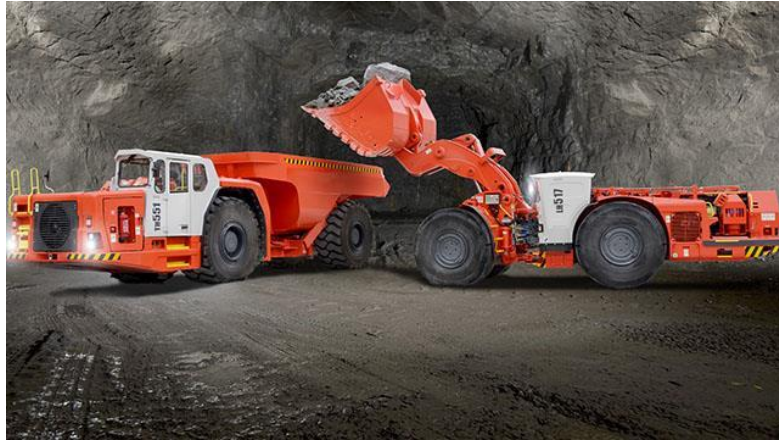
Kuva 1. Maanalaiset kaivoskoneet LH517 ja TH551 (Sandvik Mining: Equipment 2017).
