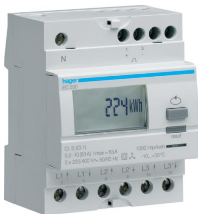
Kuva 10. Esimerkki suoraan mittaukseen perustuvasta sähköenergiamittarista (Hager EC350). Mittarin alareunaan kytketään mitattavan kuorman vaihejohtimet. [16.]
