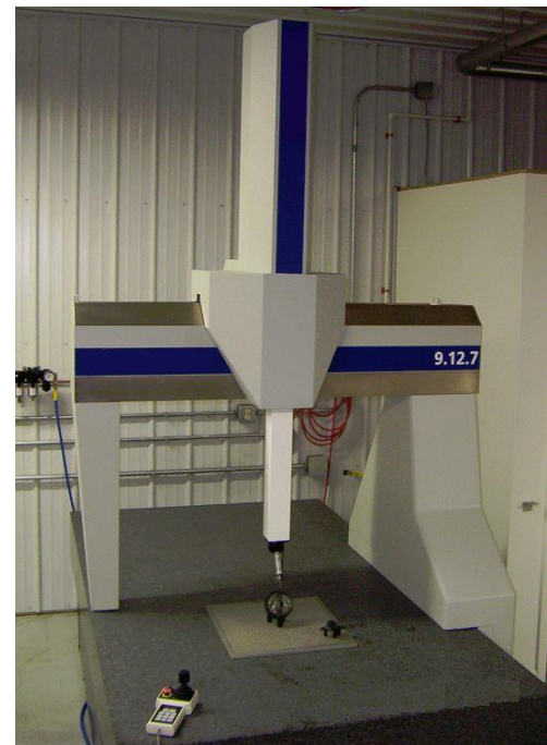
Figur 9. Exempel på hur en kontakt 3D- skanner kan se ut.
