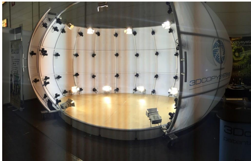
Figur 11. Exempel på en större 3D-skanner av teknik typen kontaktfri passiv. BIG ALICE av 3DCOPYSYSTEMS.
