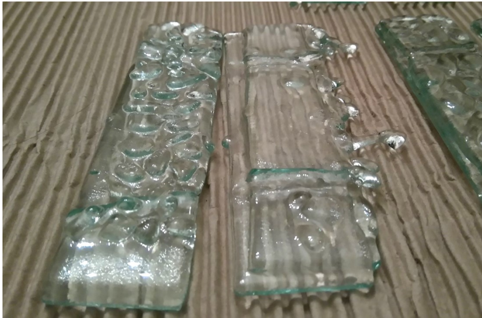
Kuva 16. Palat olivat jälleen liikahtelleet uunissa, ja osa lasimurskasta oli valunut paloilta pois.
