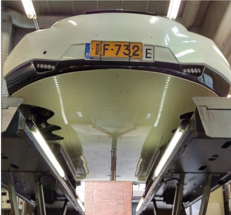
Kuva 22. Bioforeen asennettu pohjalevy.
