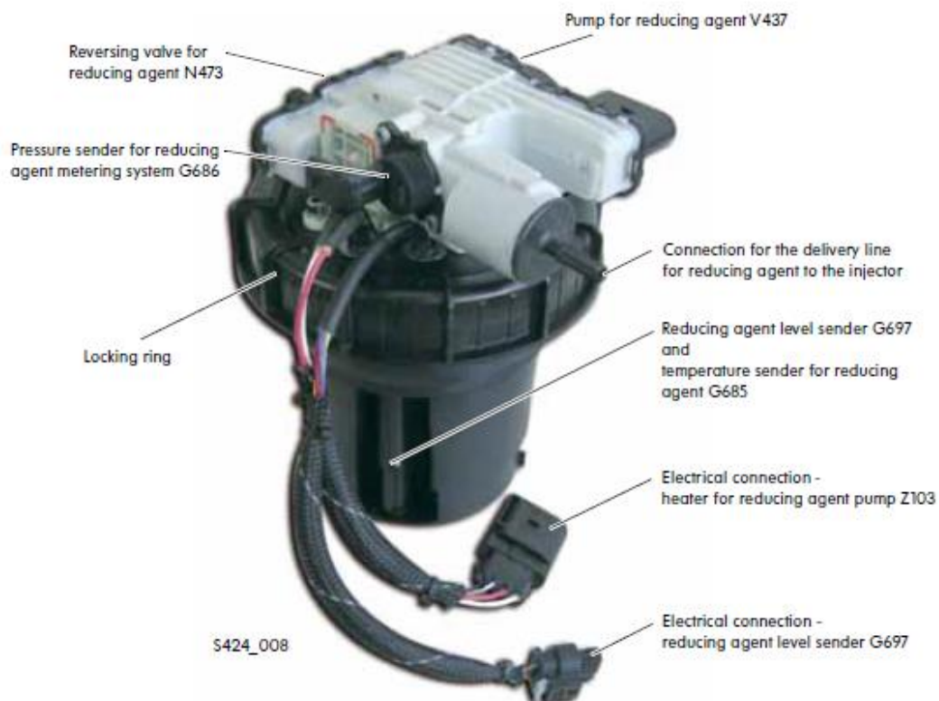
Kuva 14. Volkswagen Passatin AdBlue-pumppuyksikkö [5, s. 28].
