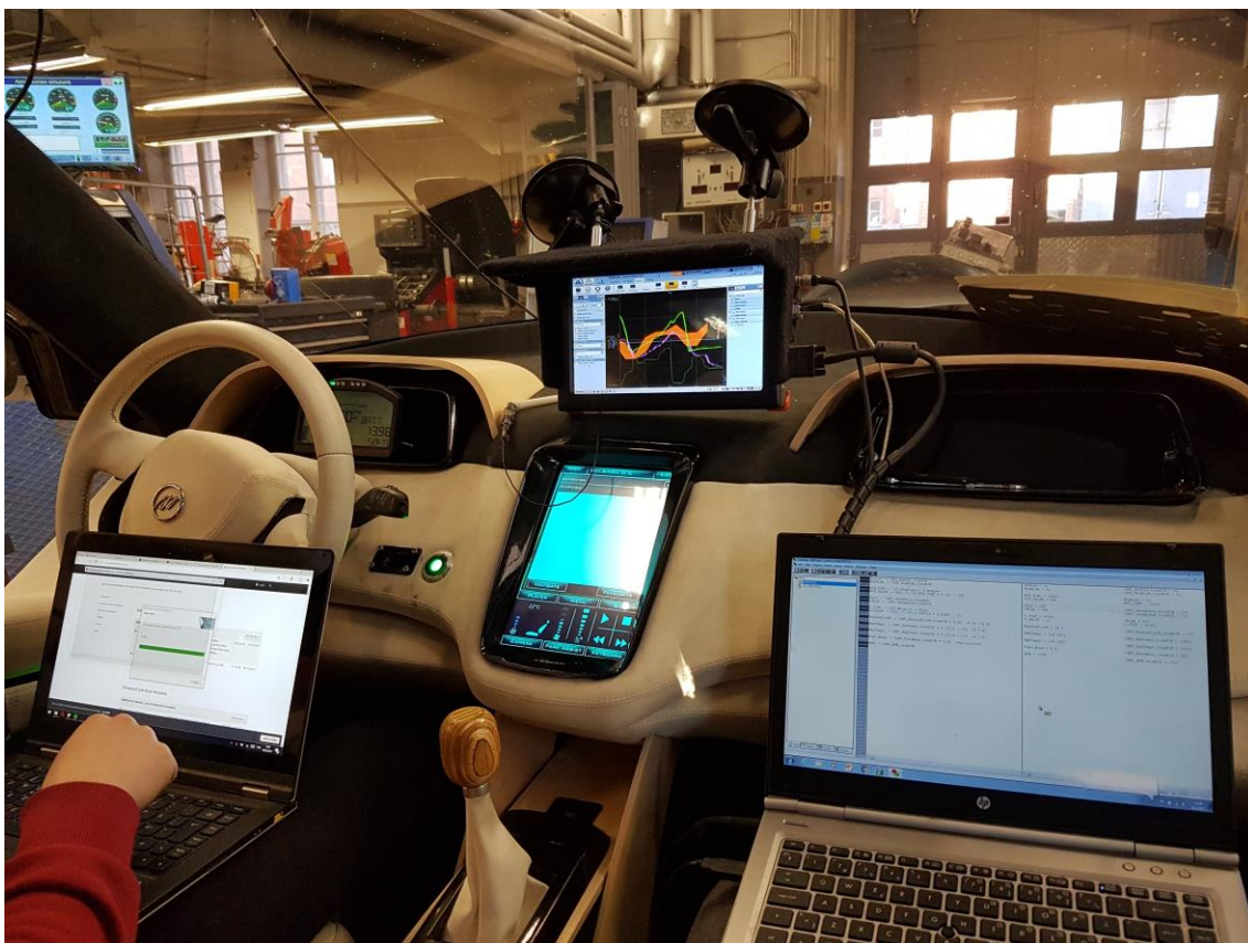
Kuva 33. SCR-järjestelmän ohjaukselle tehdään säätötoimenpiteitä dynamometrissä ajetun testin perusteella.
