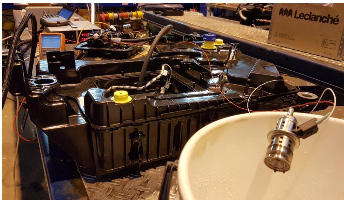
Kuva 30. SCR-toimilaitteiden ja -antureiden testausta.
