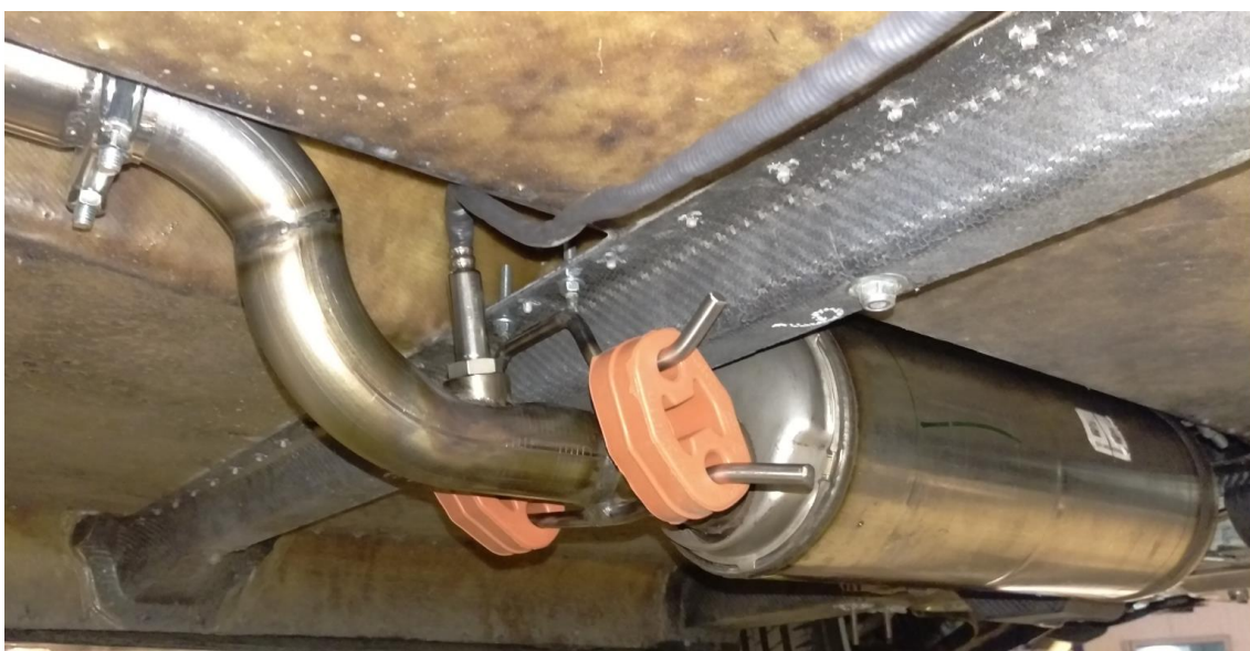
Kuva 26. SCR-katalysaattori sekä NO x -anturi asennettuna autoon.
