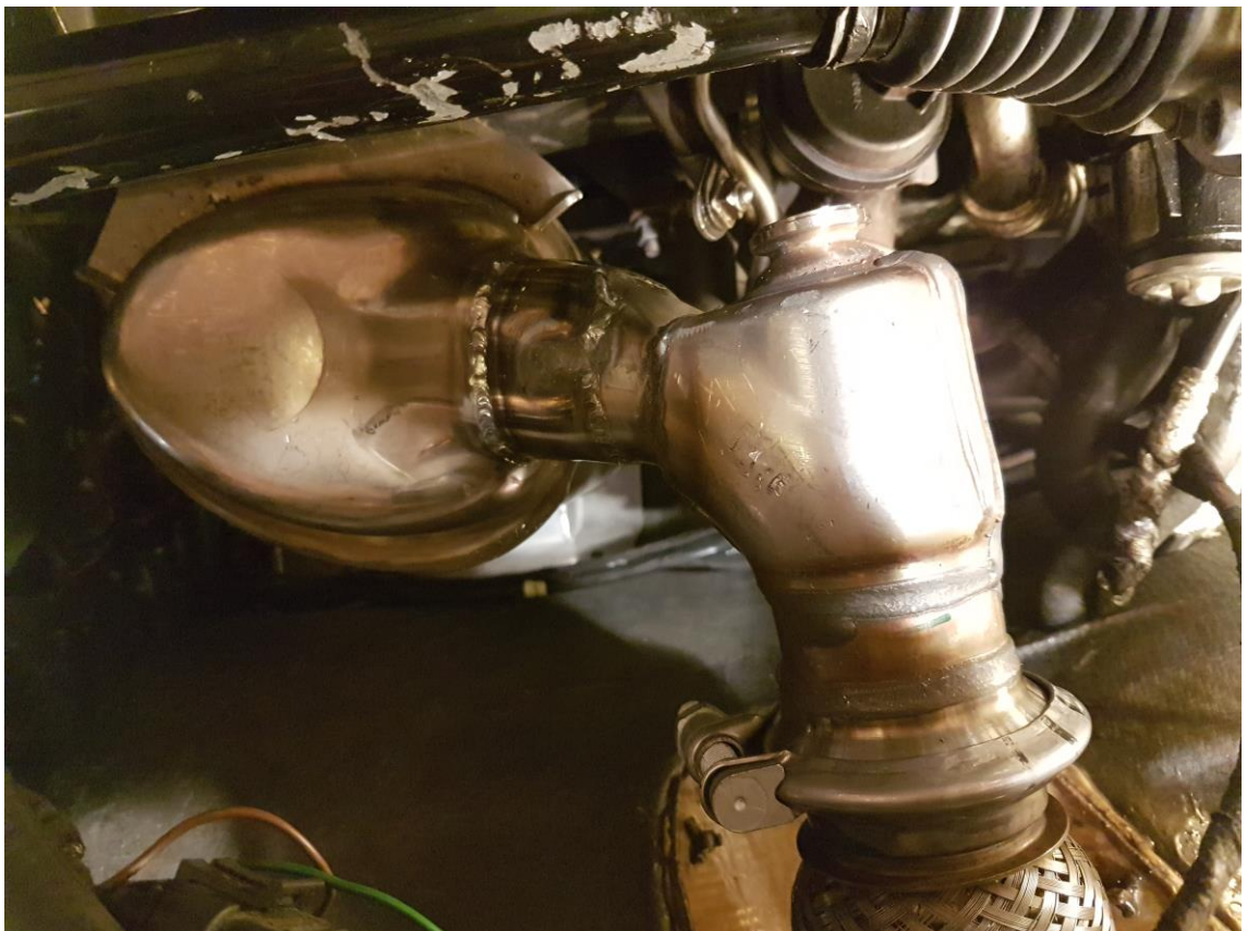
Kuva 24. Hiukkasloukkuun hitsattu AdBlue-annosteluysikön paikka.
