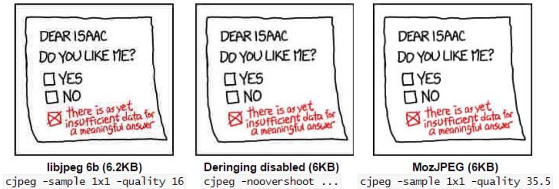
Kuva 12. MozJPEGillä pakattu sarjakuvaruutu verrattuna kahteen eri asetuksilla libjpeg-pakattuun kuvaan. MozJPEG-pakatussa kuvassa on selkeästi vähiten pakkauksesta aiheutuneita virheitä. (Lesiński 2014)
