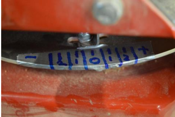
Kuva 3. RS 100 piensiemenvittimen levitinlautasen siiville tehty asteikko.
