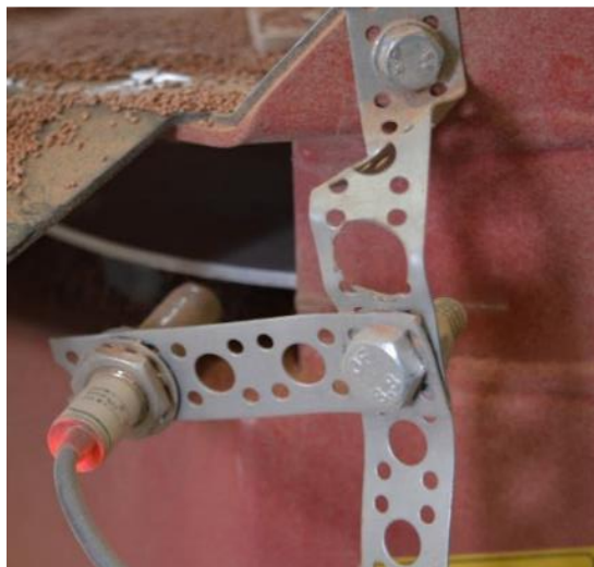
Kuva 4. RS 100 piensiemenvittimeen asennettu kierroslukumittari.
