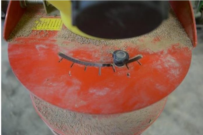
Kuva 6. APV piensiemenvittimen siemenen pudotusaukon säätö.
