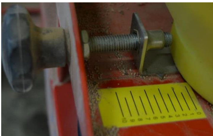
Kuva 7. APV piensiemenvittimen pohjaluukun aukon säätö.
